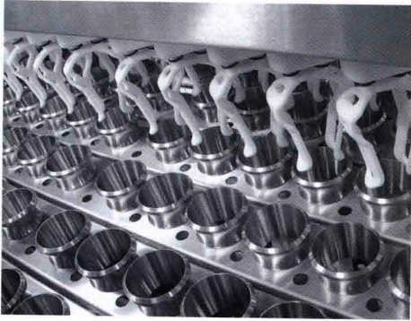
Im Choice Filler sind insgesamt 75 modular aufgebaute Polyamidgreifer verbaut
