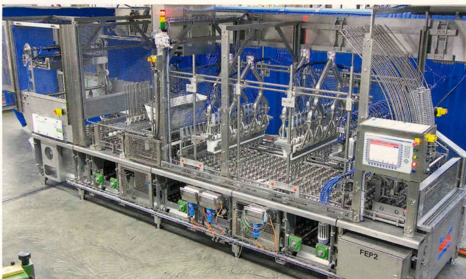
Hightech für Eiscreme: Zwischen 3 und 12 m lang ist der Choice Filler. Mit ihm lassen sich pro Stunde bis zu 50 000 Einheiten befüllen
